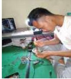
Gambar 7 Menyolder Antena GPS
