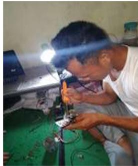
Gambar 8 Menyolder Antena SIM
