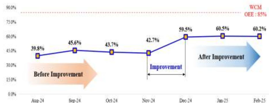
Gambar 6. Monitoring OEE untuk mesin roll forming
