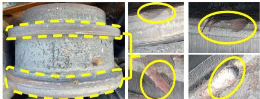
Gambar 2. Cacat *dakon* pada roller
