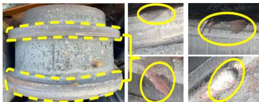
Gambar 2. Cacat dakon pada roller
