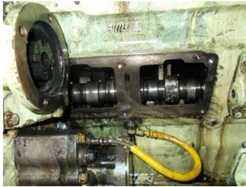
Gambar 1 camshaft terkikis pada diesel engine generator
