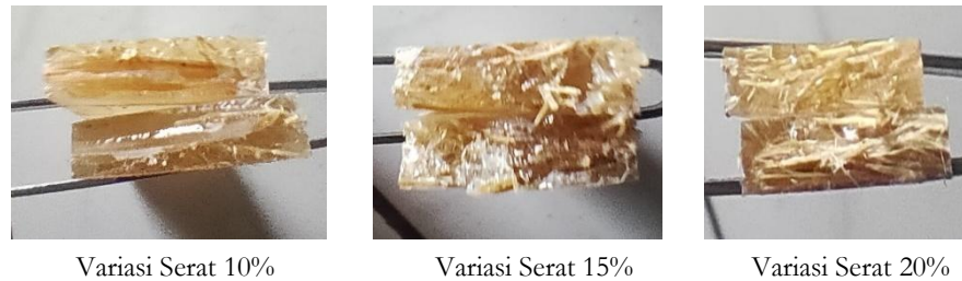
Gambar 5. Foto Makro Patahan Hasil Uji Tarik
