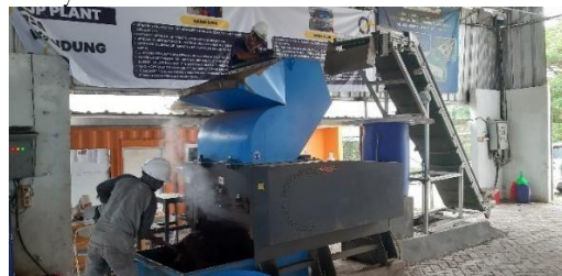
Gambar 2. Mesin Pencacah Plastik di TPSA Bagendung
