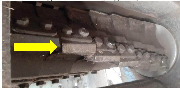
Gambar 5. Shredder Blade/Pisau Pencacah Plastik
