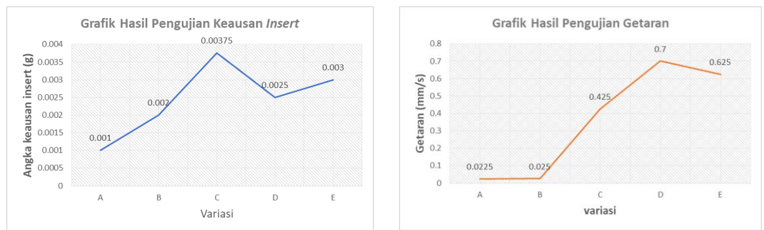
Gambar 5. Grafik hasil uji kearsan insert &amp; Uji Getaran
