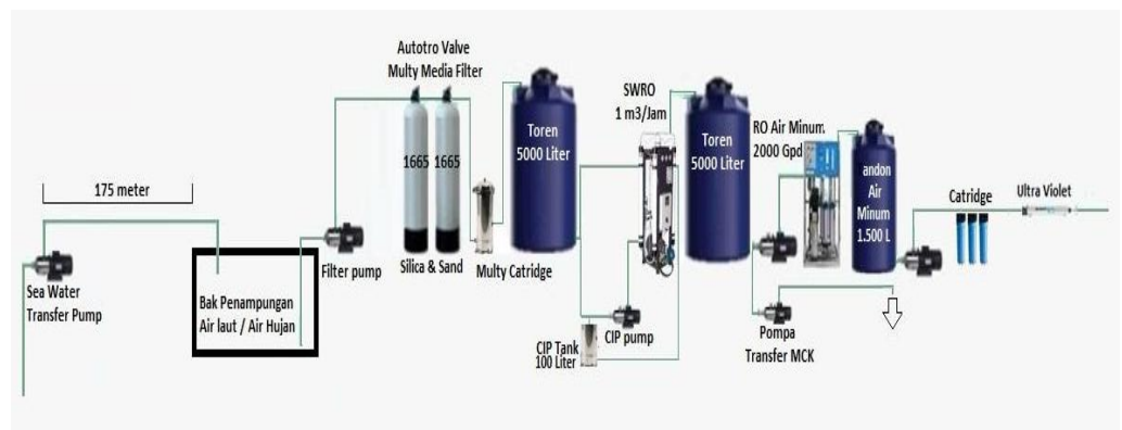
Gambar 8. Rancangan mesin RO air laut kapasitas 1000 liter/jam
