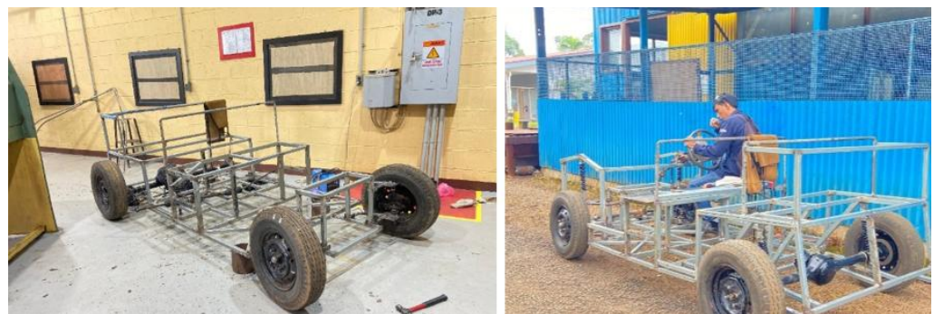
Gambar 2. Proses Perakitan Akhir dan Integrasi Sistem Motor, Diferensial
