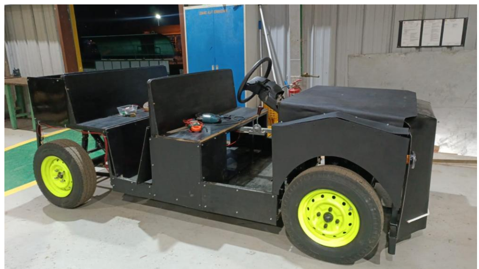
Gambar 3. Prototipe Akhir Mobil Listrik 4-Penumpang
