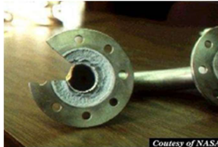
Gambar 2. 6 Korosi Celah Sumber: (Utomo, 2009)
