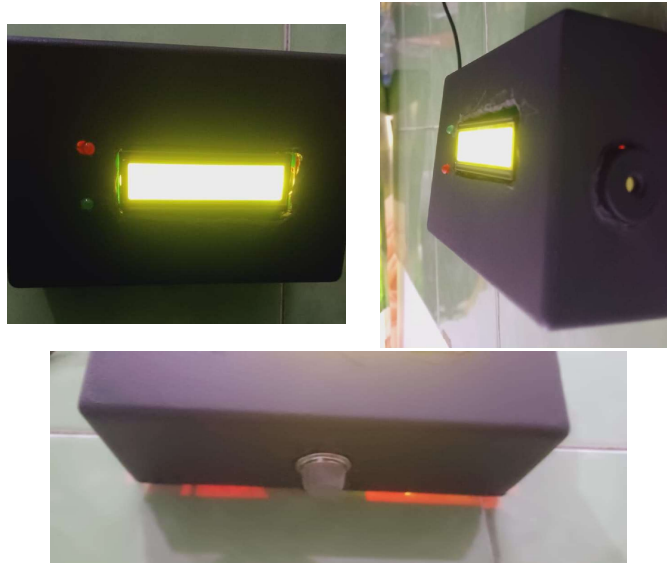
Gambar 6. Prototipe Sistem Pendeteksi Kebocoran Kompor Gas
