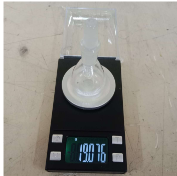
Gambar . ( a ) Nilai Timbangan Piknometer Kosong; ( b ) Nilai Timbangan Piknometer Isi.
