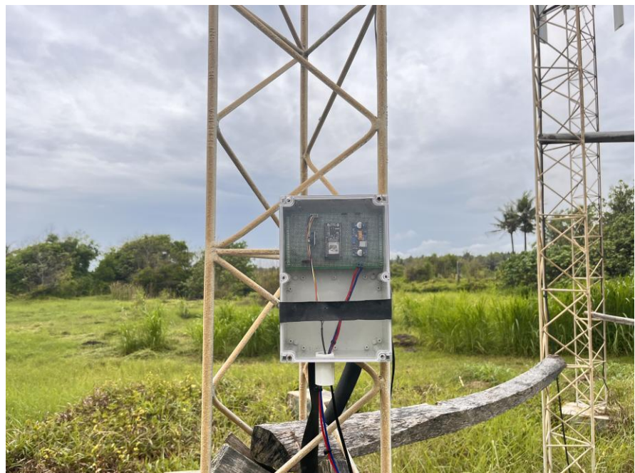
Gambar 3 node transmitter kecepatan angin penempatan di tiang anemometer
