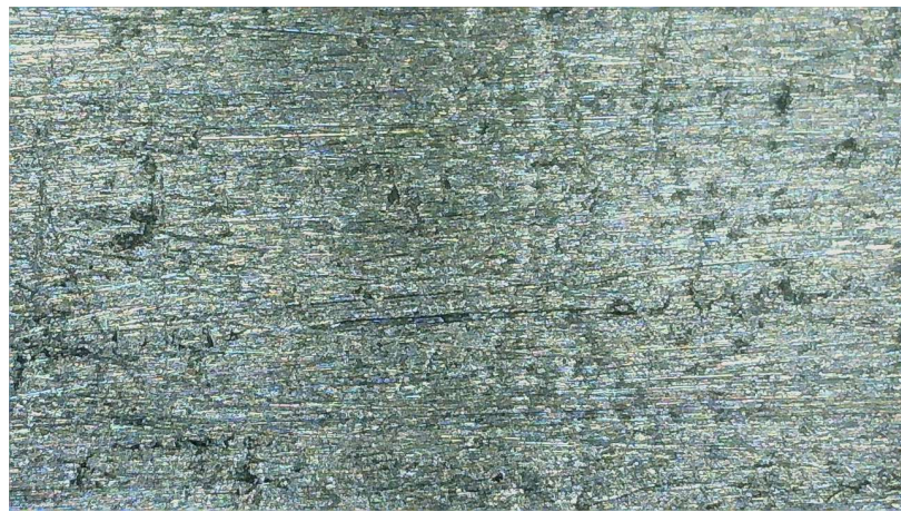
Gambar 4.12 Plat Baja ST-37 Dilas Setengah Lingkaran 120A
