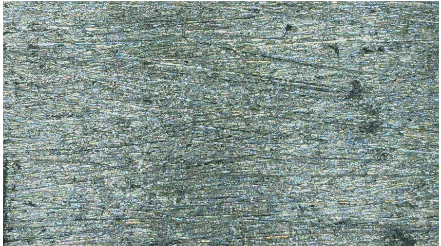
Gambar 4.6 Plat Baja ST-37 Dilas Lurus 120A
