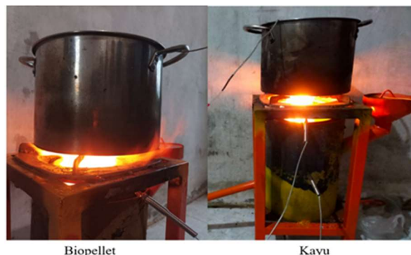
Gambar 4. Hasil Perbandingan Pembakaran Biopellet dan Kayu pada Kompur Biomassa
