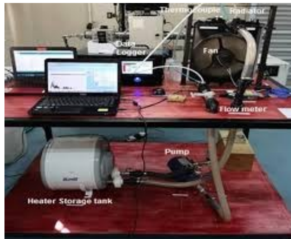
Gambar 2. Alat uji radiator otomotif
