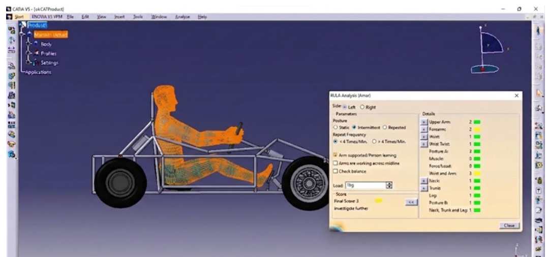
Gambar 3. Pemodelan Postur Pengemudi pada Mobil Listrik 2 kW BARATA Menggunakan CATIA V5.
