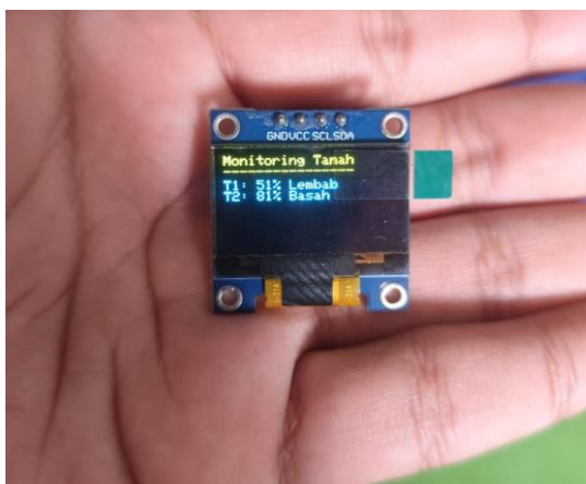
Gambar. 6. Contoh tampilan OLED sesuai status kelembaban tanah.
