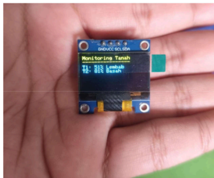
Gambar. 6. Contoh tampilan OLED sesuai status kelembaban tanah.
