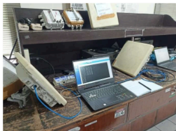
Gambar 1. Rangkaian sederhana pemasangan fisik Radio link PTP 58300
