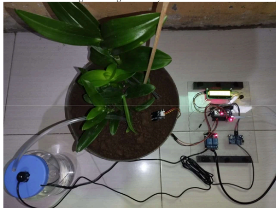
Gambar 4. 1 Prototype Sistem Penyiraman Otomatis pada Tanaman Anggrek
