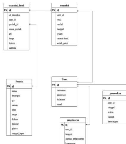
Gambar 9. Entity Relationship Diagram yang Menjelaskan Struktur Basis Data pada Sistem Informasi dan Manajemen Toko Berbasis web pada UD Berkahmart Semarang
