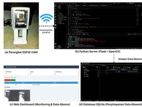
Gambar 5. Implementasi sistem absensi berbasis ESP32-CAM: (a) perangkat ESP32-CAM, (b) server Python, (c) web dashboard, dan (d) database SQLite.
