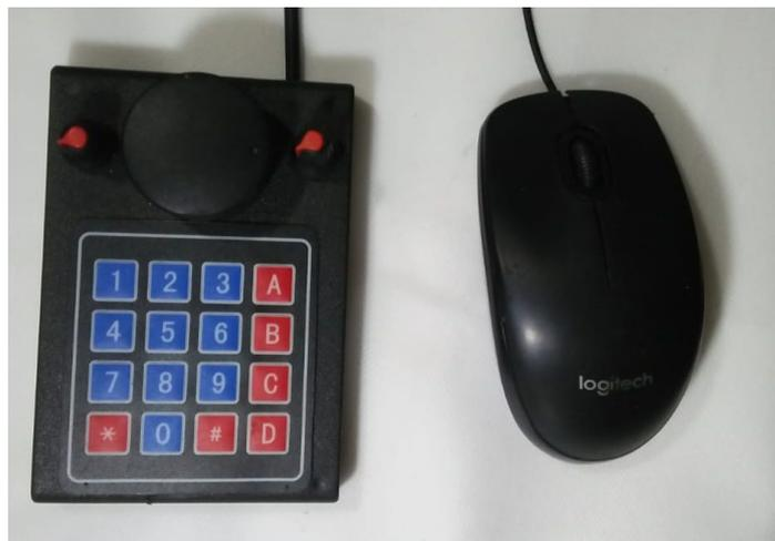
Gambar 7. komparasi ukuran alat bantu pengeditan dengan mouse standar.
