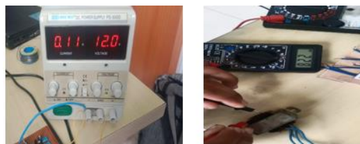
Gambar 4. Pengujian Rangkaian Inveter DC ke AC.
