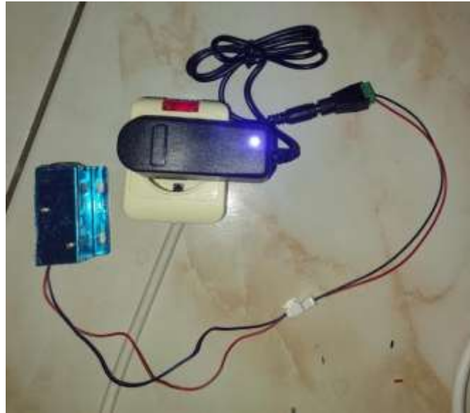
Gambar 4.8 Solenoid Door Lock tersambung sumber listrik (kondisi 2) (sumber: dokumentasi pribadi)
