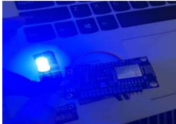
Gambar 4.6 Hasil pengujian NodeMCU ESP8266 dengan sebuah LED (sumber: dokumentasi pribadi)
