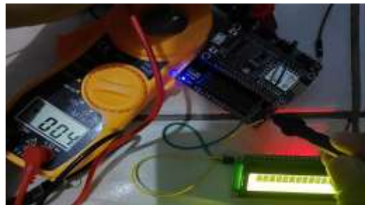
Gambar 4.5 Pengujian tegangan LCD (sumber: dokumentasi pribadi)
