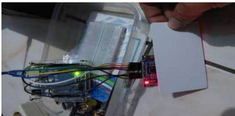
Gambar 4.1 Pengujian RFID Reader menggunakan kartu kosong (sumber: dokumentasi pribadi)
