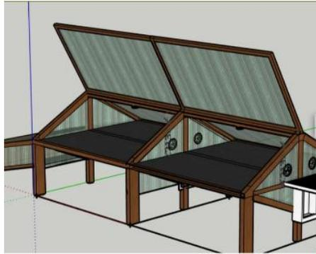
**Gambar 4.** Penambahan kapasitas alat dengan sistem modular.
