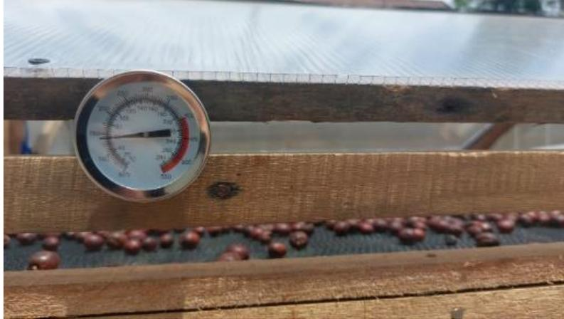
**Gambar 8.** Proses Monitoring Pengeringan Kopi dengan Solar Dryer Modular.
