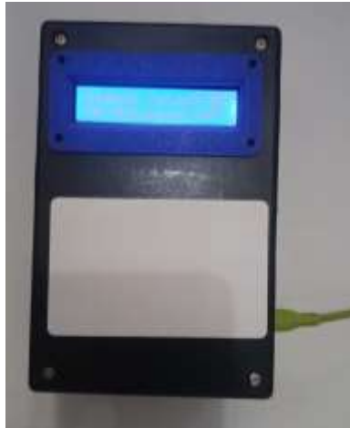
Gambar 7. Tampilan Luar dan Kartu RFID
