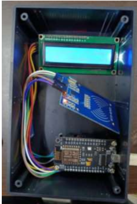
Gambar 6. Rangkaian NodeMCU, RFID, Buzzer dan LCD
