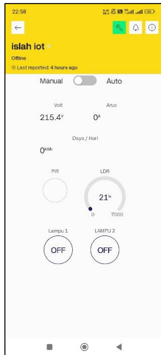
Gambar 3. Kondisi Blynk Saklar OFF (kiri), Kondisi Lampu OFF (kanan)
