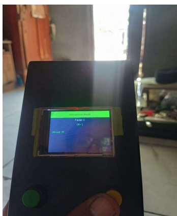
Gambar 3. Prototipe perangkat absensi hasil implementasi. Sumber: Dokumentasi penelitian.
